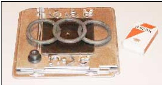
Einen Tag lang sieht man J. W. in seinem Keller zeichnen und werkeln, bis er zufrieden das unspektakuläre Ergebnis präsentiert. Am Ende hat Shooter für eine seiner Actionboxen viereinhalb Stahlbleche, 6 Haken, 3 Gummiringe und eine Schraube gebraucht und alles in allem weniger als 20 DM ausgegeben. Die fertige Box wiegt 1,5 Kg und paßt 'gefaltet' beinahe in seine Jackentasche (15 x 15 x 2cm).
