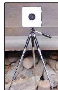
Natürlich hat Shooter daran gedacht, das Unterteil der Box mit Löchern für Stellschrauben (Bodenaufstellung) und einem passenden Gewinde für Fotostative zu versehen. Außerdem soll seine Box auch ohne Elektronik (Ampel) funktionieren. Deshalb kann man die Klingelglocke aus dem Pendel auch in der Box benutzen.
