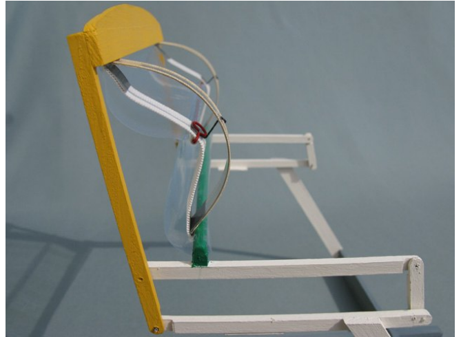
Abb. 54: Abschlußspiegel fast Waagerecht. Die durchgebogene Blattfeder zieht den Gurt am Bändchen nach
