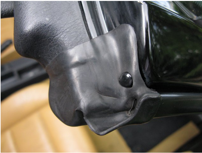
Abb. 80: Gummiendkappe mit Wasserablauf
