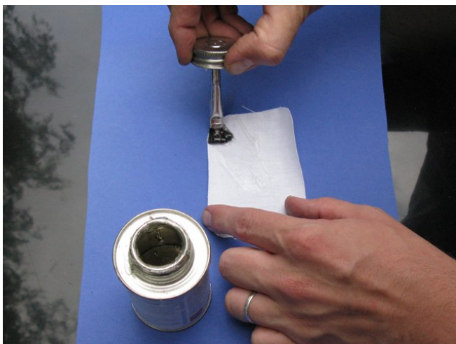
Abb. 107: Bestreichen des Stoffstückes
