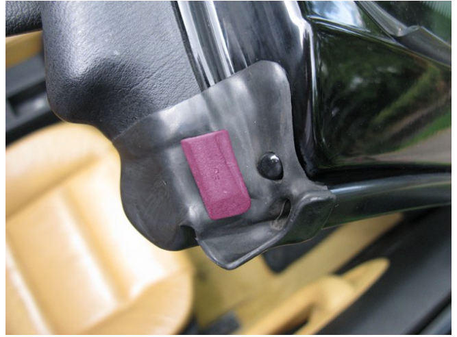
Abb. 81: Position des Füllstückes (zu besserer Erkennbarkeit nur aufgelegt und rot eingefärbt)
