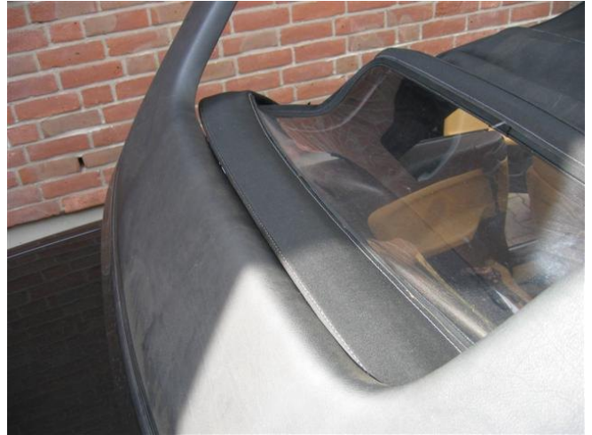
Abb. 85: Der Spannbügel drückt sich vorbei
