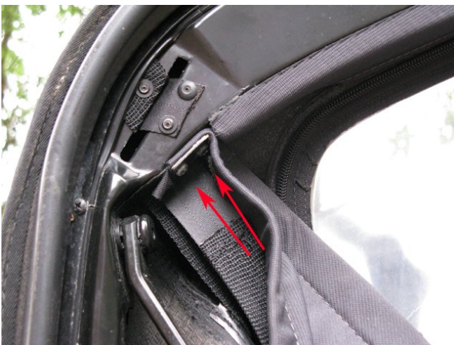
Abb. 103: Innenhimmelbefestigung am Spannbügel
