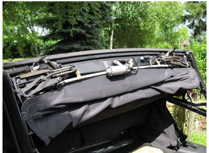
Abb. 21: Verschlusspiegel mit Motor M3 (rechts S7 und S8 an der Mechanik)
