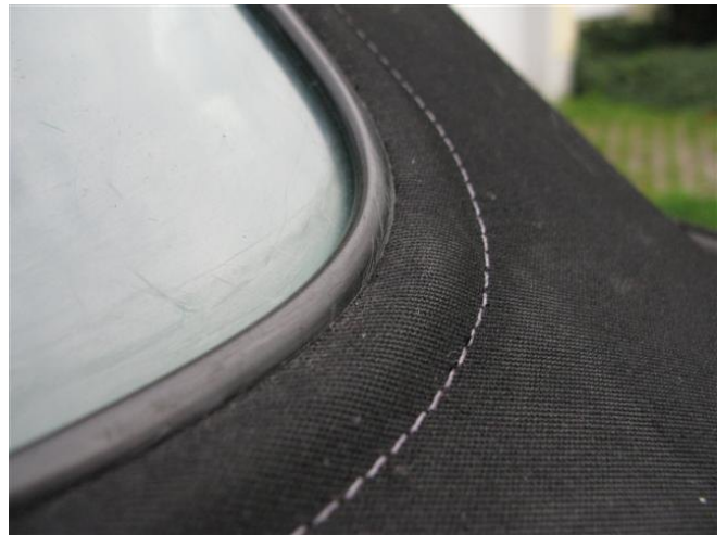
Abb. 43: Wieder eingedrückter Verdeckrand beim Z3
