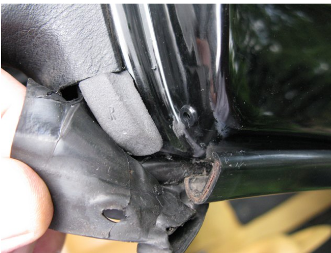
Abb. 82: Tatsächliche Lage des Füllstückes unter der Gummiendkappe
