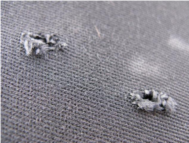
Abb. 101: Löcher in der Verdeckhaut der "C-Säule"
