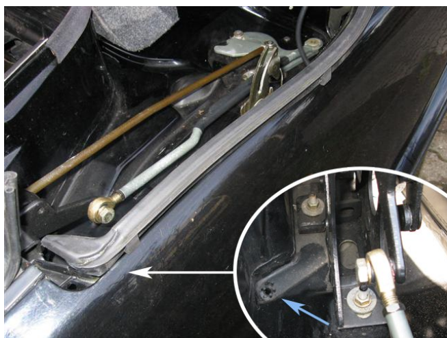
Abb. 76: Dichtungsgummi und Wasserablauf (blauer Pfeil)
