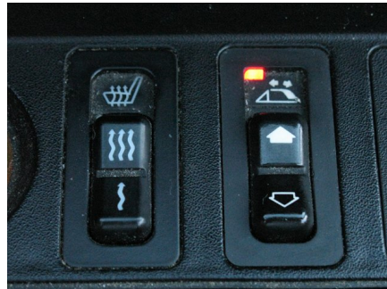
Abb. 8: Verdeckschalter bei halb- und vollautomatischem Dach
