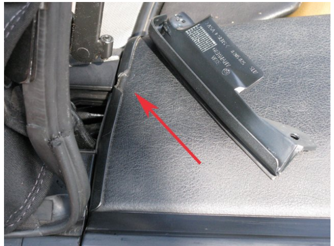
Abb. 70: Beschädigte Verdeckdeckelkante und Neuteil
