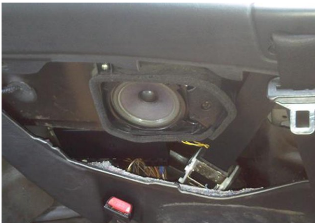
Abb. 23: Einbauort Cabrio Verdeck Modul (CVM)
