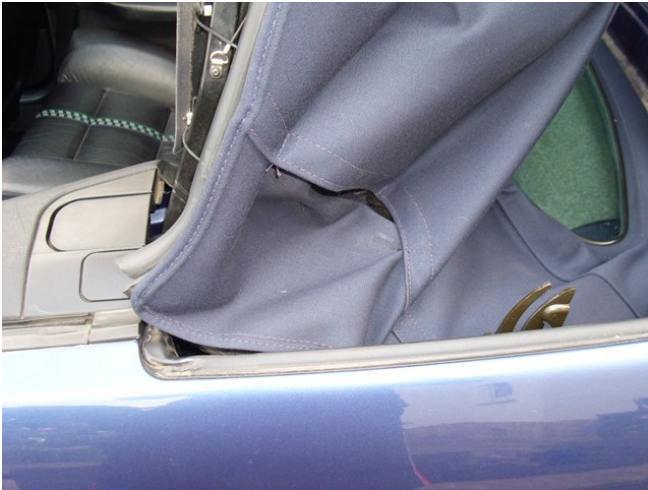
Abb. 12: Sollfaltstelle mit "Zwangsbelüftung"
