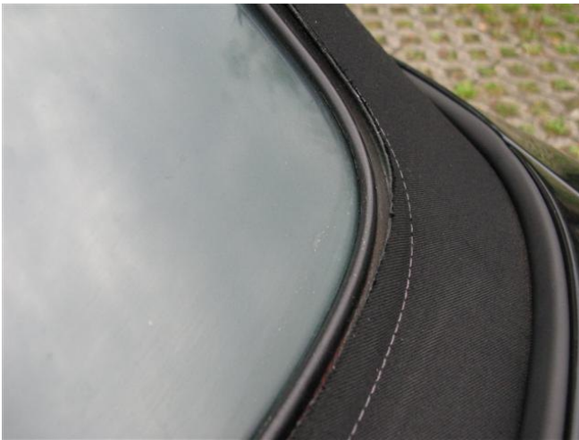
Abb. 42: Komplett gelöster Rand beim Z3
