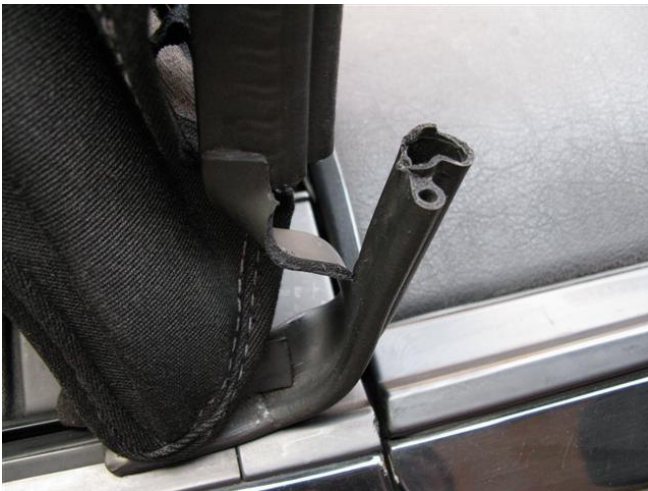
Abb. 116: Gerissene Dichtung am Spannbügel
