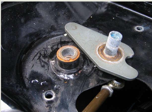
Abb. 17: Rostbefall nach Undichtigkeit
