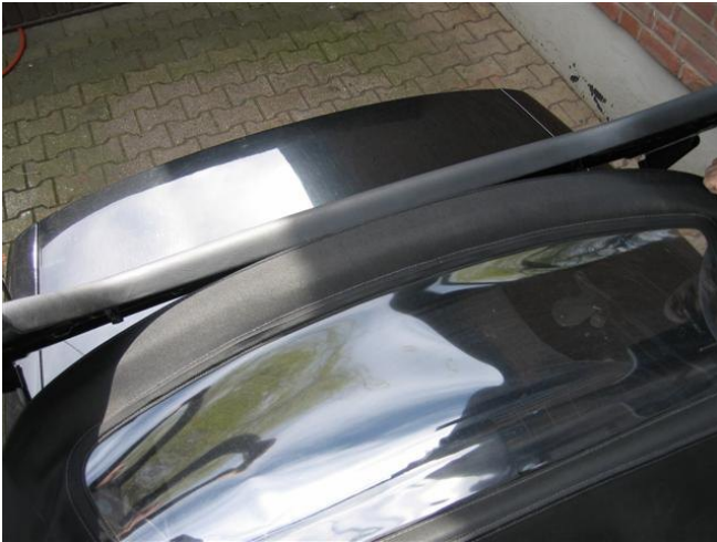
Abb. 84: Spannbügel schlägt auf den Verdeckdeckel
