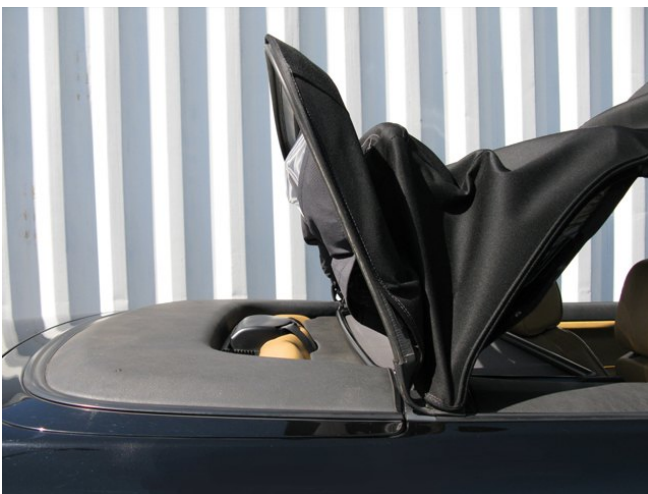
Abb. 59: Spannbügel nicht senkrecht (Heckscheibenbügel nicht umgeklappt)
