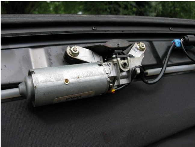
Abb. 20: Motor M3 Im Verschlusspiegel betätigt über eine Welle die beiden Verschlusskrallen.
