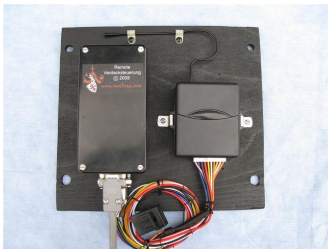
Abb. 94: Komplette Schaltung auf einer 265x240mm großen Sperrholzplatte montiert
