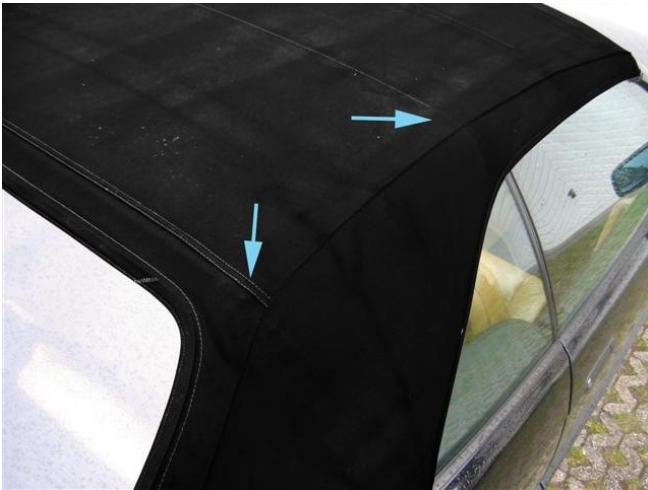
Abb. 65: Ungefähre Position der Befestigungspunkte
